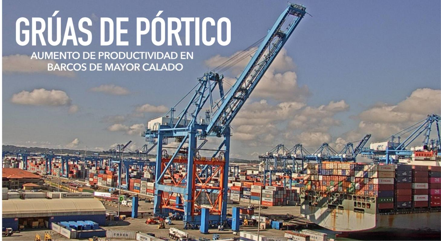
Este proyecto de elevación de las grúas de pórtico, que permite manejar cargas en barcos NEO PANAMAX, ha aumentado el conocimiento en estructuras y manejo de cargas pesadas (heavy load) a ingenieros y personal de campo panameños. Tres grúas de pórtico se izaron de 36 metros a 47 metros de área de manejo de carga. Una cuarta grúa se encuentra en su fase final de armado al momento de redactar este artículo.
