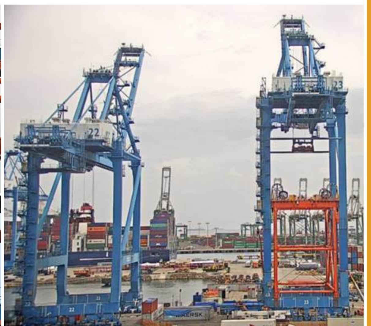
Completado el trabajo de alzar las cuatro patas de la grúa No. 23 (derecha), podemos ver la diferencia con la altura de la grúa No. 22 (izquierda)
